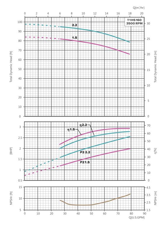
TIGERFLOW T1HS SERIES STAINLESS STEEL SINGLE-STAGE CENTRIFUGAL PUMPS
