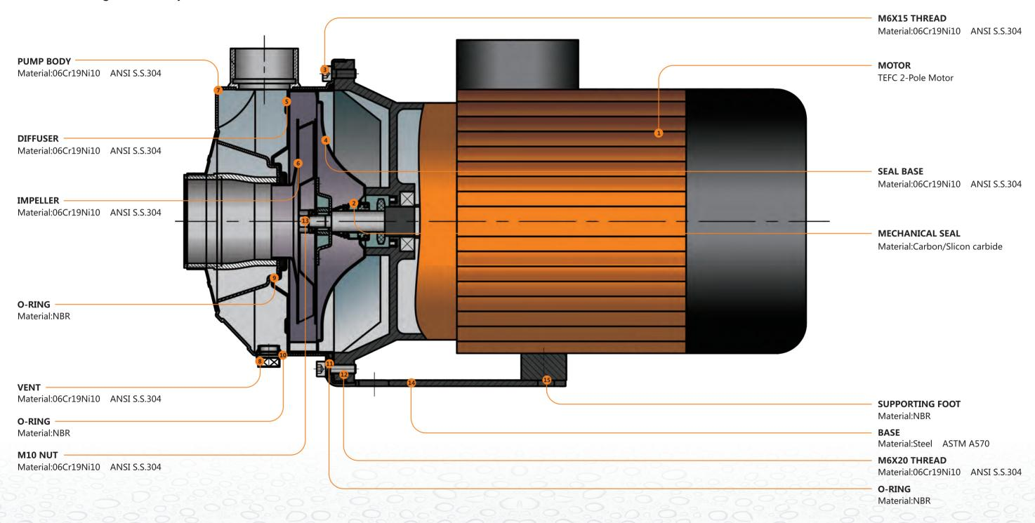
TIGERFLOW T1HS SERIES STAINLESS STEEL SINGLE-STAGE CENTRIFUGAL PUMPS
